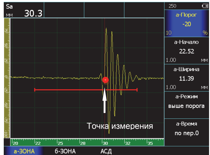
Рис.3-5 Измерение времени прихода сигнала 'по переходу через нуль'
