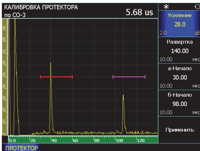
Рис.3-13 Калибровка наклонного преобразователя по образцу СО-3
