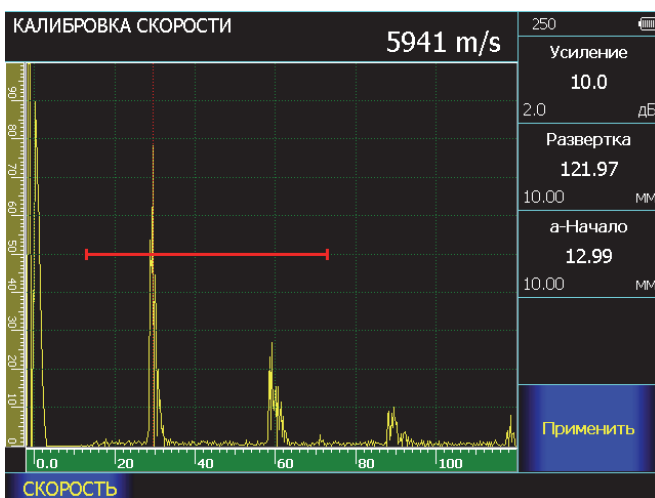
Рис.3-16 Экран калибровки скорости
