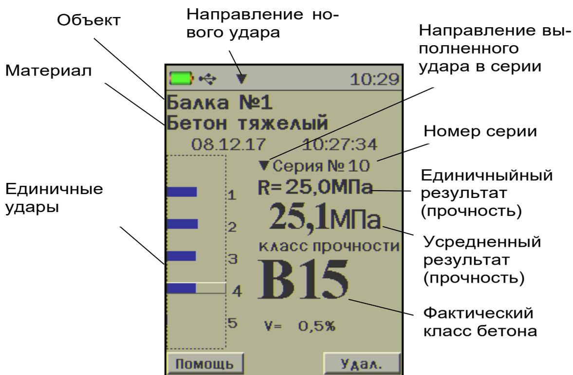
Рисунок 3 - Пример индикации результата серии измерений.
