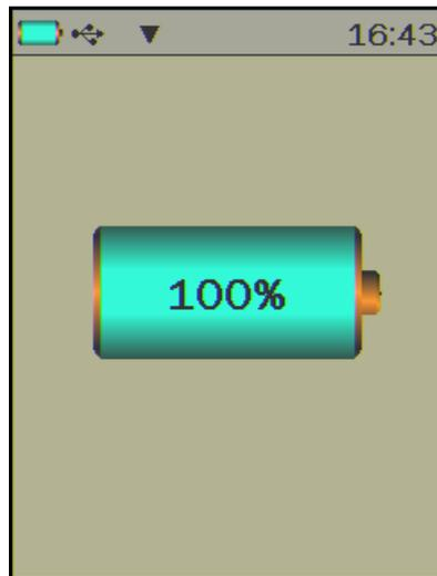
При включении прибора на дисплее кратко- временно выводится информация о текущем заряде аккумулятора в процентах. Если появляется сообщение «**Зарядите АКБ**» или прибор выключается сразу после включения, следует зарядить аккумулятор (см. п. «**Техническое обслуживание**»).
