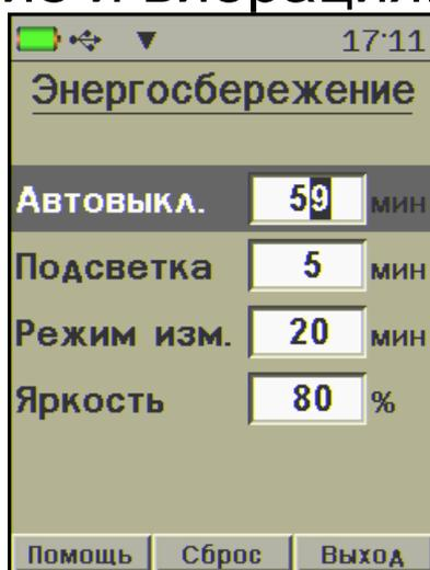
«**Автовыкл., мин**» - время до автоматического выключения прибора при отсутствии действий с ним. Диапазон изменения времени до автовыключения прибора составляет от 1 до 59
